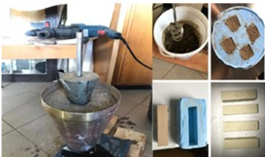
Imagini ale etapelor privind determinarea consistenței mortarelor, obținerea epruvetelor pentru încercările mecanice
